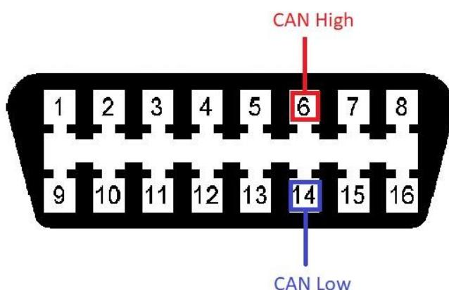
Подключение CAN2: на диагностическом разъеме OBD-II.
